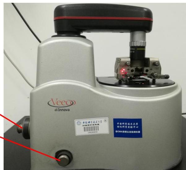
将激光照射在悬臂梁的前端
