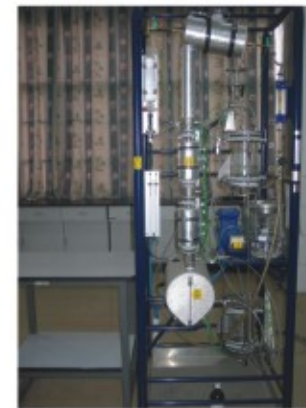
ArmField UOP3CC-A 连续反应精馏塔
